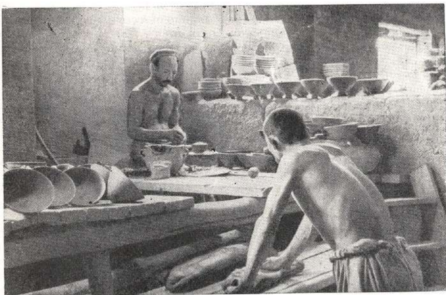
Рис. 59. Промешивание глины руками; на заднем плане чашки с неподрезанными донцами. Риштан. (МАЭ, колл. № И-1503-448).
