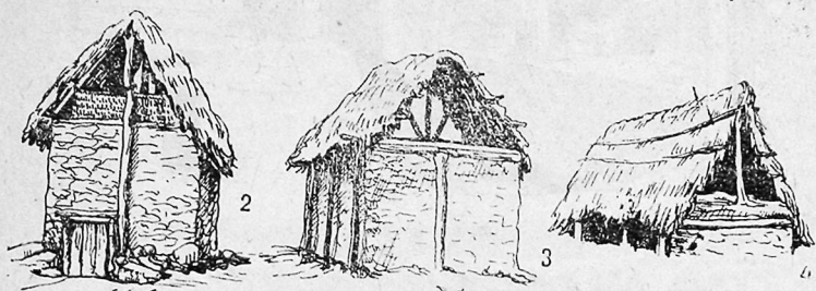
Рис. 7. Различные виды укрепления двускатной камышовой крыши в дарвазских кишлаках. Рисунки с фото 1956 г.: 1—магазин в к. Тогмай; 2—4—кладовые при жилых домах в к. Джорф.
